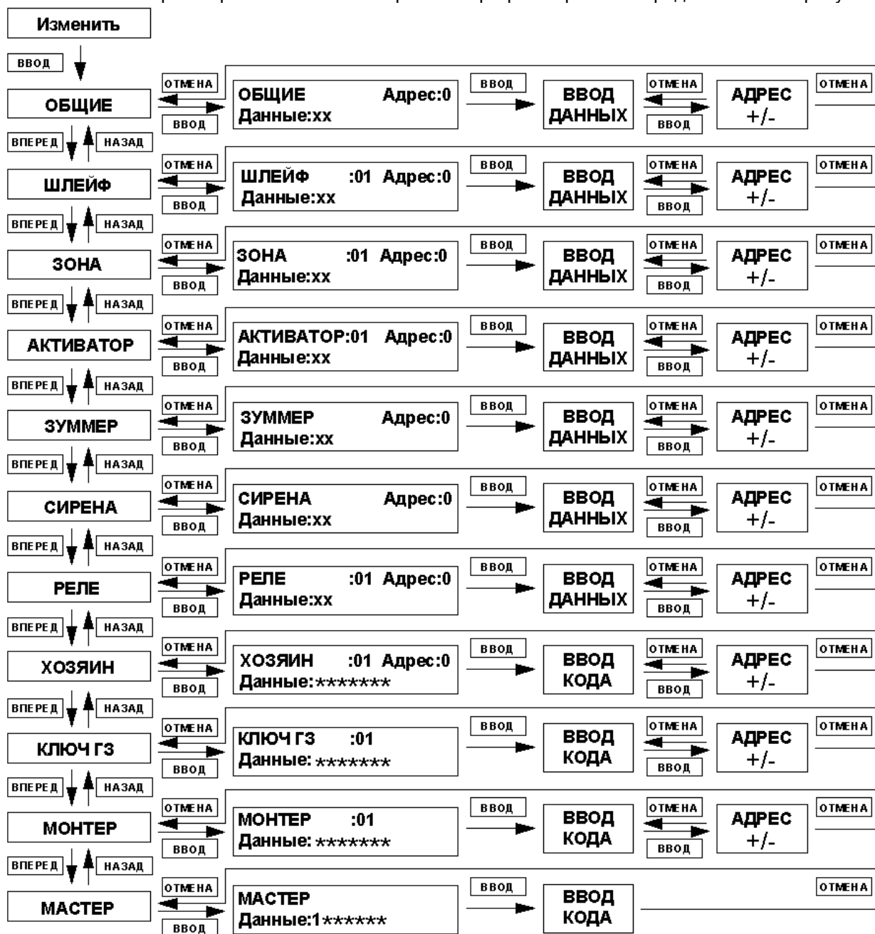
Рисунок 25 - Блок схема алгоритма работы ВПУ-А-06 в режиме программирования
