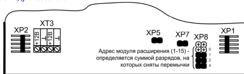
Рисунок 2. Расположение контактов и контактных колодок на печатной плате модуля расширения.
